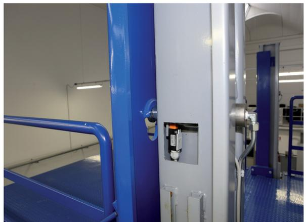
Detalle del bloqueo mecánico en la planta.
