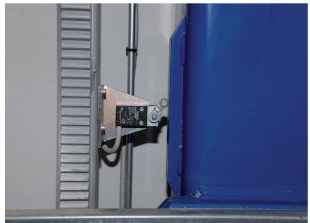
En la foto superior se pone en evidencia el detalle de un ejemplo de finales de recorrido colocados en la máquina.
