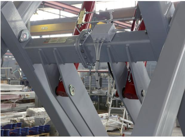
Foto del empalme de la viga central, con al lado la caja de enlace de la instalación eléctrica.
