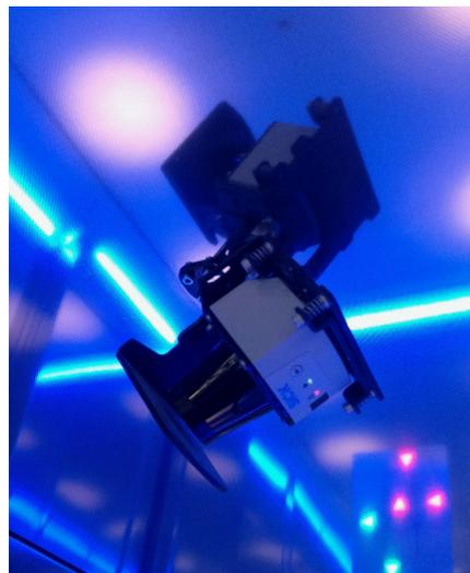
En cuanto el propietario salga de la celda de entrada, el sistema, a través de los laser scanners, escaneará el vehículo para averiguar que todas las medidas quepan dentro de la plataforma, de manera que no se dañe el coche durante el proceso de movilización y aparcamiento.
